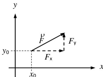
Ausgehend vom Startpunkt  $x_0$  und  $y_0$  ist der Kraftvektor  $\vec{F}$  durch die Kraft in  $x$ -Richtung mit  $F_x$  und in  $y$ -Richtung mit  $F_y$  eindeutig bestimmt:
