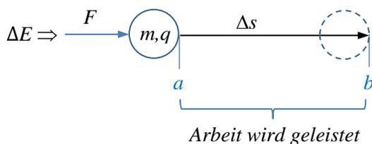
Ist die Kraft konstant über dem Wegstück  $\Delta s$  und sind Kraft- und Verschiebungsrichtung identisch, dann berechnet sich die Verschiebungsarbeit  $\Delta W$  mit:  $\Delta W = F \cdot \Delta s$
