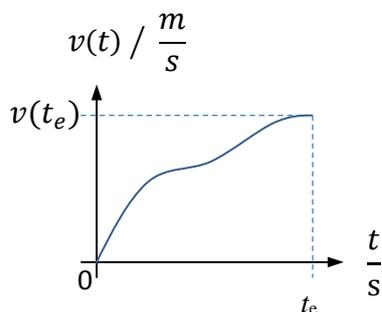
Das Geschwindigkeitsdiagramm hat als x-Achsengröße die Zeit in Sekunden und als y-Achsengröße die Geschwindigkeit in Metern pro Sekunde.
