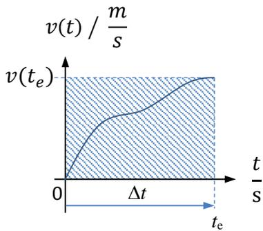
Die Multiplikation der Endgeschwindigkeit  $v(t_e)$  mit der Zeitdauer  $\Delta t$  kann nicht die Lösung sein. Das Objekt hat ja erst zum Schluss bei  $t_e$  die Endgeschwindigkeit erreicht. Geometrisch gedeutet entspricht in dem x-y-Diagramm eine Multiplikation der Achsengrößen immer einer Rechteckfläche:  $A = x \cdot y$
