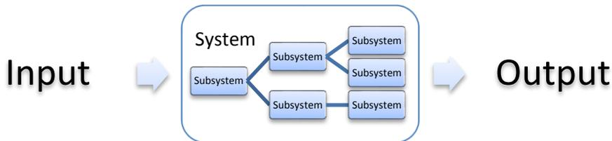
Ein Subsystem, wie beispielsweise eine Baugruppe, besteht aus mehreren Elementen (den Bauteilen), die wiederum untereinander in Verbindung stehen und die Funktion des Subsystems bestimmen. Jedes Bauteil (Element) hat eine bestimmte Funktion.
