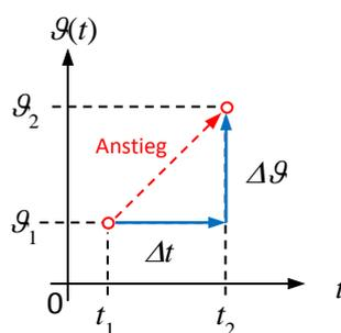
Ein Raum wird aufgeheizt: Zum Zeitpunkt  $t_1$  wird die Temperatur  $\vartheta_1$  und zum Zeitpunkt  $t_2$  die Temperatur  $\vartheta_2$  gemessen.  $\vartheta_1$  und  $\vartheta_2$  werden als Augenblicks- oder Momentanwert bezeichnet.
