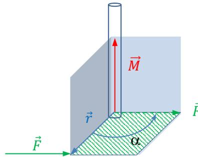
Die Kraft wird parallelverschoben, sodass beide Vektoren den gleichen Ursprung haben.
