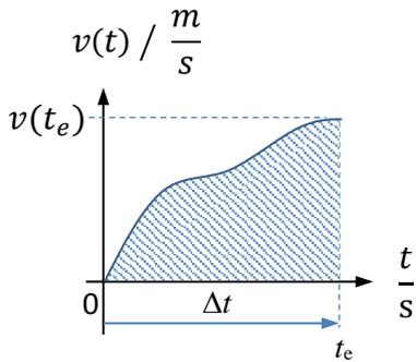
Der zurückgelegte Weg kann eigentlich nur der Fläche unter dem Geschwindigkeitsverlauf entsprechen, da eine Fläche immer einer Multiplikation der y- und x-Achsengrößen entspricht.
