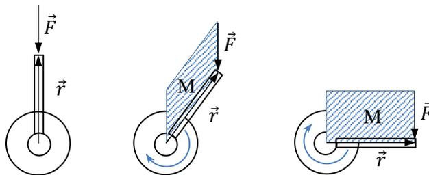
Die Fläche, die zwischen den beiden Vektoren aufgespannt wird, entspricht dem Betrag des Drehmomentes.
