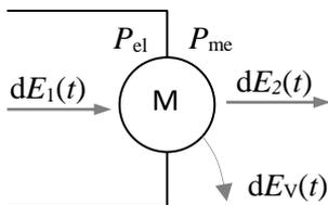
Elektrische Energie wird dem Motor zugeführt und mechanische Energie abgegeben. Auf der elektrischen Seite kann die elektrische Leistung  $P_{el}$  und auf der Antriebswelle die mechanische Leistung  $P_{me}$  gemessen werden.
