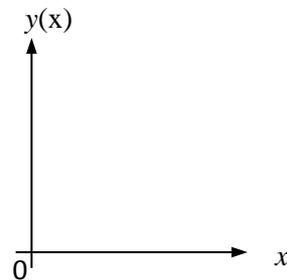
Die Achsen stehen  $90^\circ$  aufeinander (orthogonal), dieses System wird als kartesisches Koordinatensystem bezeichnet. Die Achsen schneiden sich im Koordinatenursprung, der mit „0“ gekennzeichnet ist.
