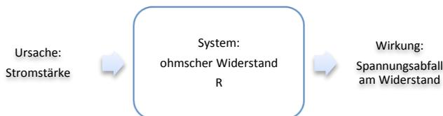
Eine Vorhersage des Systemverhaltens ist nun mittels ohmschen Gesetzes leicht möglich:
