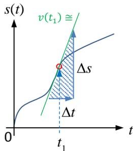
Der oben beschriebene Vorgang wird nun ohne Vergrößerung durchgeführt. Genau in dem Zeitpunkt, in dem die Geschwindigkeit ermittelt werden soll, wird die Tangente angelegt und die Steigung der Tangente ermittelt. Der Steigungswert entspricht dann in etwa dem Geschwindigkeitswert in diesem Zeitpunkt:  $v(t_1) \cong \frac{\Delta s}{\Delta t}(t_1)$
