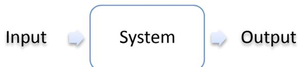
Beim technischen System Motor wird eine äußere Energie zugeführt (Eingangsgröße), um als Wirkung eine mechanische Energie (Rotation der Antriebswelle) zu erhalten. Technische Systeme wandeln also immer Energien um.
